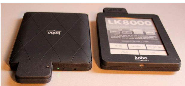
Rialzo 5mm, interruttore, led e cavo microUSB
